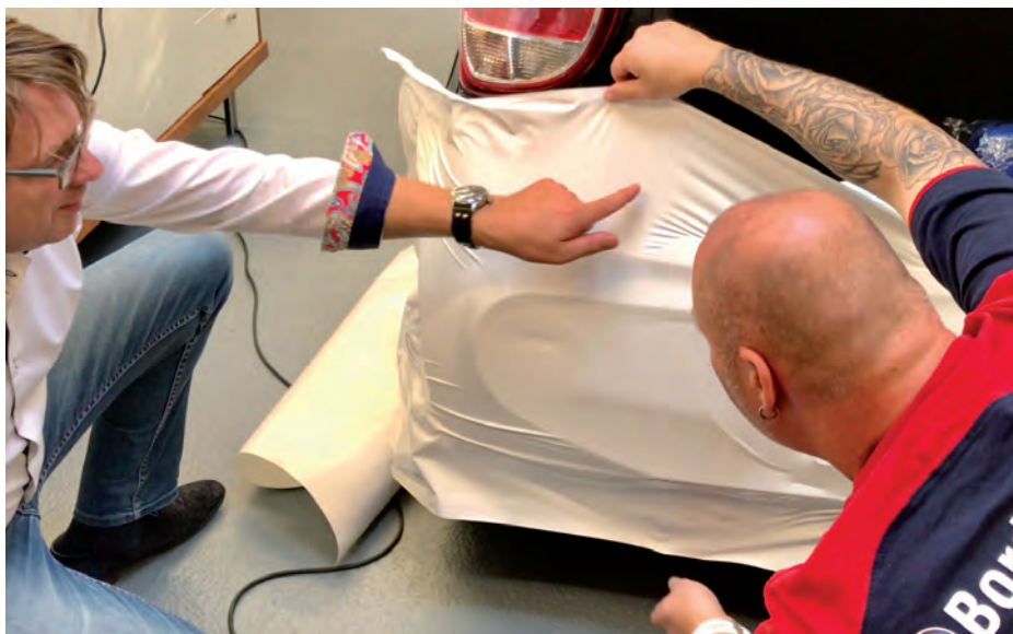
Slimme carwraptechnieken hebben veel te maken met het optimaal verdelen van de folie over de auto.
