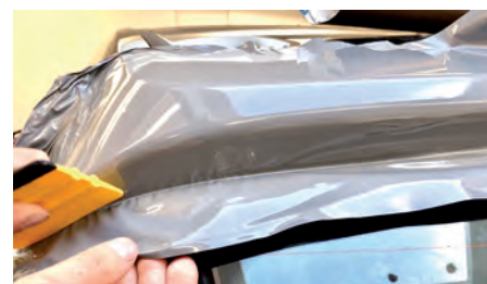
Door vooruit te denken en de spanning in de folie slim te verdelen, voorkom je dat je met te veel spanning (plooiën) langs de randen eindigt.
